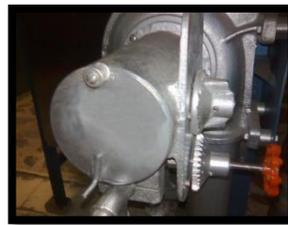
**C-2. Máquina sin encendido automático:** Se abren puertas, se prende antorcha, se abre la llave de paso del gas y se acerca la antorcha, piso por piso empezando por abajo. Se verifica que prendan todas las boquillas. Se cierran puertas.
