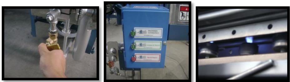
**d) Elaboración de tortilla:** Una vez que ha transcurrido el tiempo adecuado para que la maquina adquiera la temperatura adecuada para la correcta cocción de la tortilla (de tres a cinco minutos), se sube la palanca de clutch para dejar ir la tortilla. (Advertencia: Cuando la masa llegue a tener algún pequeño grano de maíz en la masa se observará que la tortilla sale rallada. En estos casos hay que abrir con el trinquete y volverlo a cerrar a su ubicación para recoger el grano)
