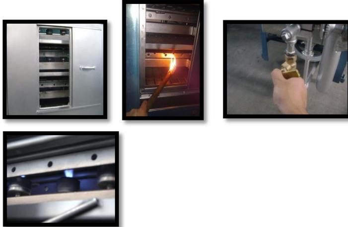
**C-3. Maquinas con encendido automático:** Se abre la llave de paso del gas, se aprieta el botón de encendido automático, se espera cinco segundos. Se verifica que prendan todas las boquillas.
